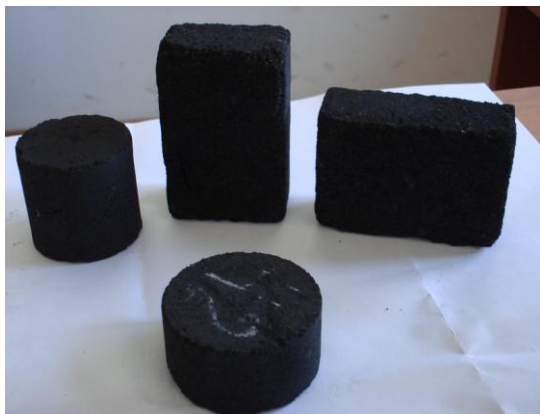
Рисунок 3 – Брикеты для чугунолитейного производства (связующее вещество меласса)
