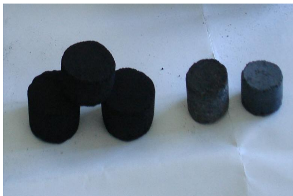
Рисунок 4 – Брикеты для ферросплавного производства и газогенераторных установок (связующее вещество меласса)
