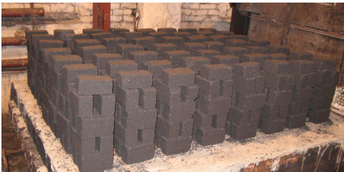
Рисунок 3 – Брикеты для чугунолитейного производства (связующее вещество меласса)
