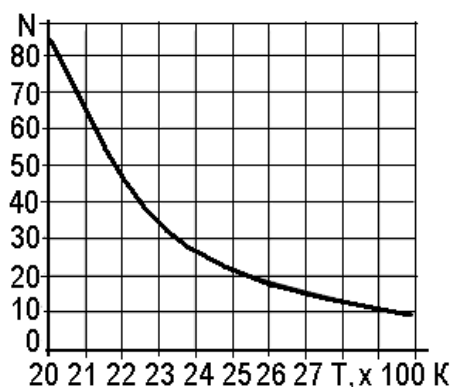
Рисунок 5 – Участок номограммы – зависимость отношения показаний ФЭУ после красного и синего светофильтров от температуры пламени
