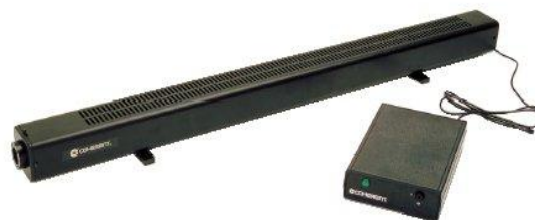
Рисунок 1 – Лазер High Power – 632,8 nm Red Helium Neon Lasers (P=35 мВт; длина волны – 632,8 нм; расходимость – 0,66; ширина полосы – 165 МГц)
