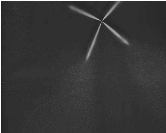
Рисунок 9 – Штатный распылитель 6A1, впрыск рапсового масла
