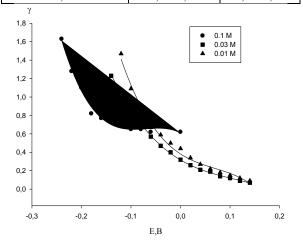
Рисунок 3. Зависимость  $\gamma$  от потенциала контактной стороны мембраны
