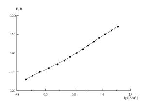
Рисунок 2. Поляризационная кривая контактной стороны. Концентрация  $NaH_2PO_2\ 0.01M$
