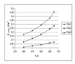
Рисунок 1 — Зависимость скорости коррозии стали Ст.3 от температуры: ряд 1 — электрохимический метод, концентрация NaCl 290 г/л; ряд 2 — электрохимический метод, концентрация NaCl 310 г/л; ряд 3 — гравиметрический метод, концентрация NaCl 310 г/л
