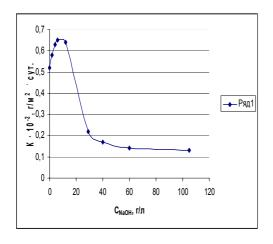
Рисунок 3 — Зависимость скорости коррозии стали от концентрации добавки гидроксида натрия в растворе хлорида натрия: концентрация хлорида натрия 220 г/л; T = 293 K
