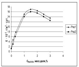
Рисунок 4 — Зависимость скорости коррозии стали от концентрации хлората натрия: ряд 1—раствор NaOH 50% + NaClO $_3$  0,3%; ряд 2 — раствор NaOH 50%; T = 333K
