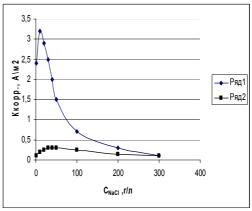
Рисунок 2 — Зависимость скорости коррозии стали от концентрации хлорида натрия: ряд 1 — электрохимический метод; ряд 2 — гравиметрический метод  $T=293\ K$
