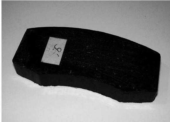
Рисунок 1 – Фрикционная накладка "ВАЗ"
