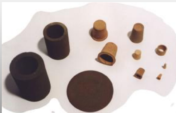
Образцы фильтрующих элементов, полученных методом СВС
