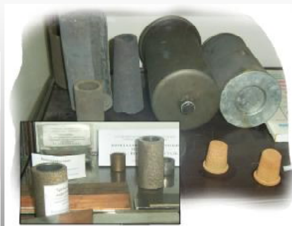
Образцы фильтрующих элементов, полученных методом СВС
