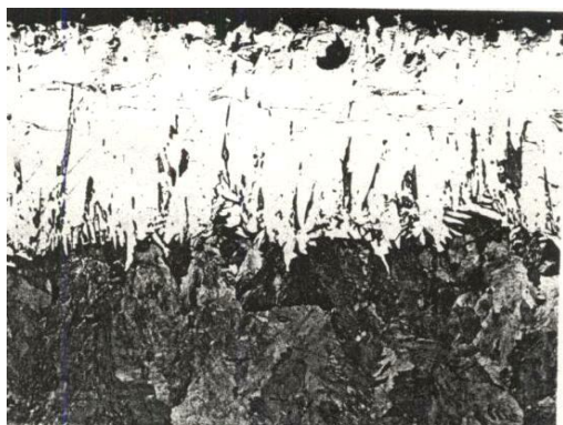
Рисунок 1 – Микроструктура боридных покрытий (х 175)
