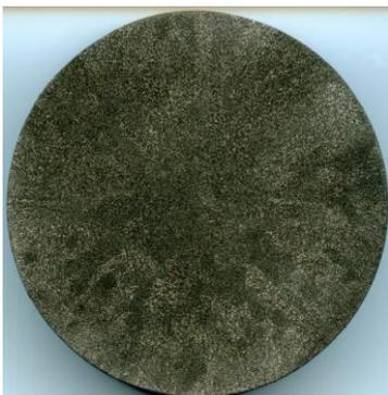
Рисунок 1 – макроструктура слитка, (диаметр 50 мм)
