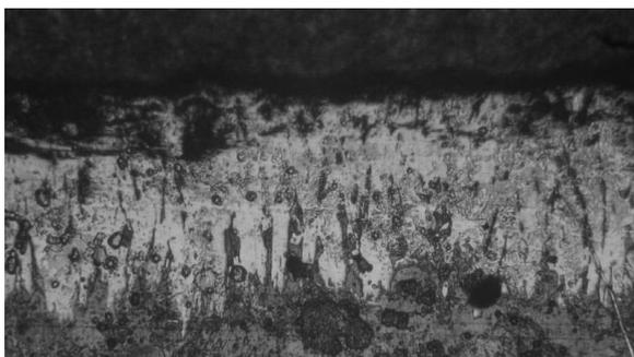
Рисунок 3 – Борированный слой на стали 40ХЛ (x 200)
