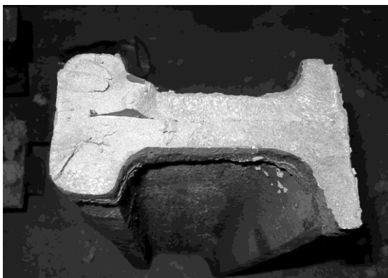
Рисунок 6 – Излом сварного соединения, полученный при испытаниях на статический трехточечный изгиб
