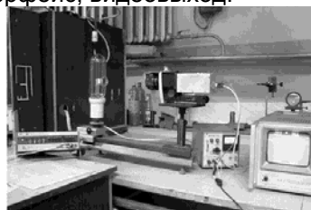
Рисунок 5-Схема калибровочного стенда: источник постоянного тока; 2-калиброванная вольфрамовая лампа Си 10-300; 3-лента накопления с отмеченным участком; 4- светофильтр; 5-бинокулярный микроскоп МБС-9; 6-крепление-переходник фотокамеры; 7- цифровая фотокамера (пирометр)
