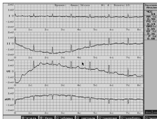
Рис. 1. Пример дрейфа изолинии при регистрации ЭКГ в велоэргометрии прибором ЭФКР-4
