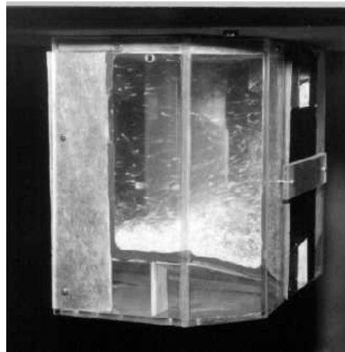
Рис.3. Картина удержания опилок в модели вихревой дубль-топки с вертикальной осью вращения вихря
