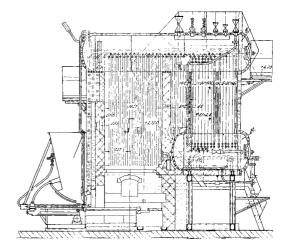
Рис.5. Котел KE-4-14 OCB с топкой шурующая планка, котельная Барнаульского маслобойного завода
