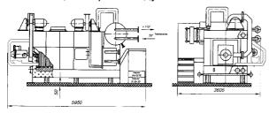
Рис.3. Котел УСШ-1 для сжигания лузги, резервное топливо газ
