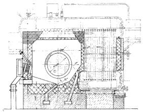
Рис.2. Реконструкция котла ДКВр-4-13 на сжигание лузги в вихревой топке радиального типа, резервное топливо природный газ
