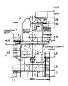
Рис.1. Вид котла E-16-2,1-350 ГМДВ с фронта (в двухэтажной компоновке): внизу вихревая топка, блок котла сверху
