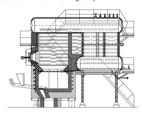
Рис.4. Котел КЕ-10-14 ОГВ, установленный в котельной ОАО «Чишминское»
