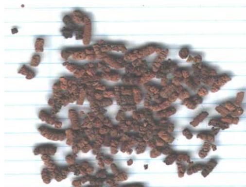
Рис.4. Зола в виде гранул после огневого обезвреживания ила
