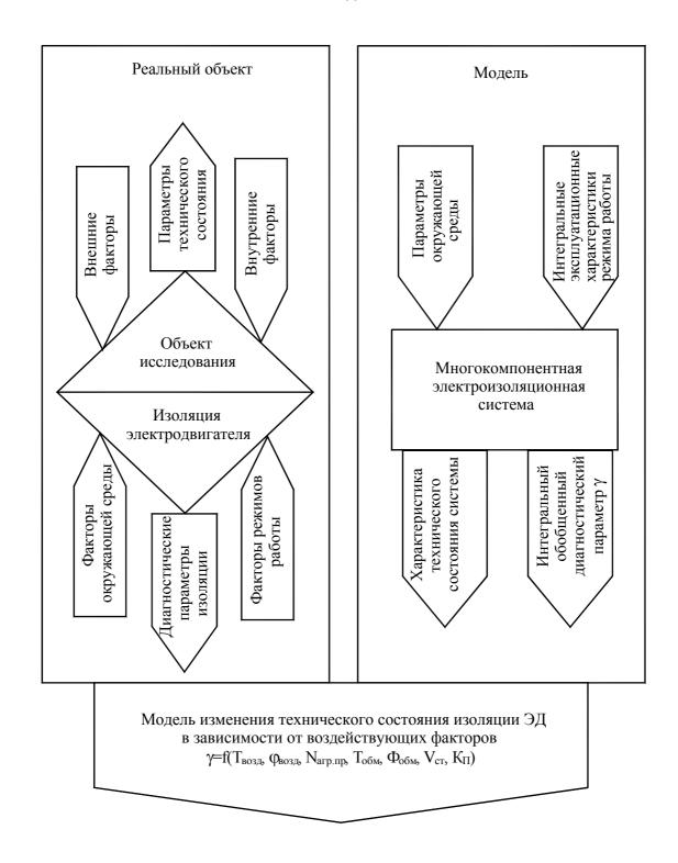
Рис. 1. Описание модели старения изоляции ЭД.
