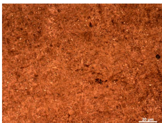
Рисунок 2 – Микроструктуры образцов стали У8 после ТЦО: а) образец № 03 ( T_{\text{в}} = 780^{\circ}\text{C} ); б) образец № 14 ( T_{\text{в}} = 860^{\circ}\text{C} )
