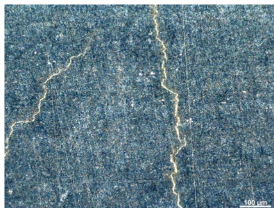
Рисунок 2 – Микроструктуры образцов стали У8 после ТЦО: а) образец № 03 ( T_{\text{в}} = 780^{\circ}\text{C} ); б) образец № 14 ( T_{\text{в}} = 860^{\circ}\text{C} )
