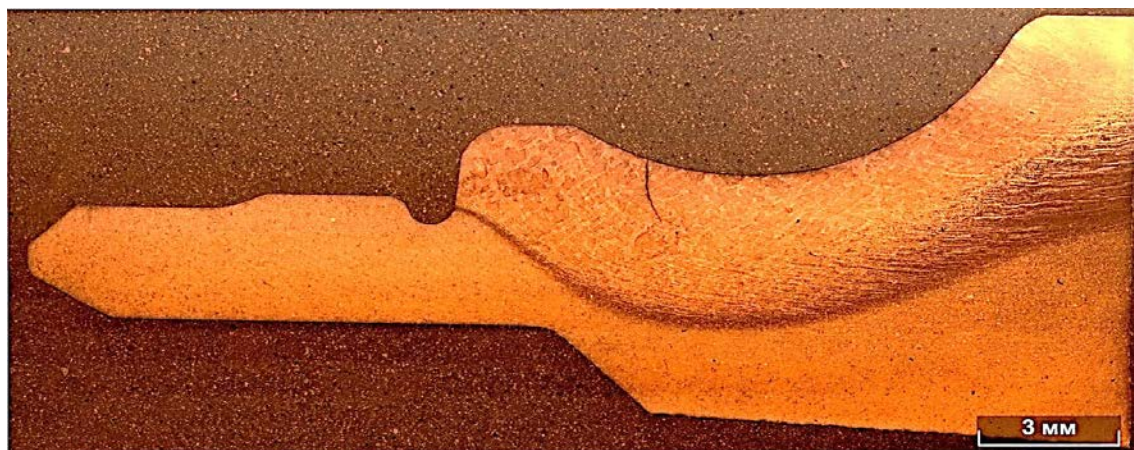
Рисунок 1 – Панорамное изображение упрочненной обоймы подшипника x 50
