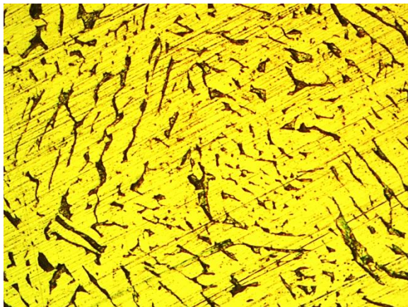
Рисунок 2 – Структура литой латуни, х 100
