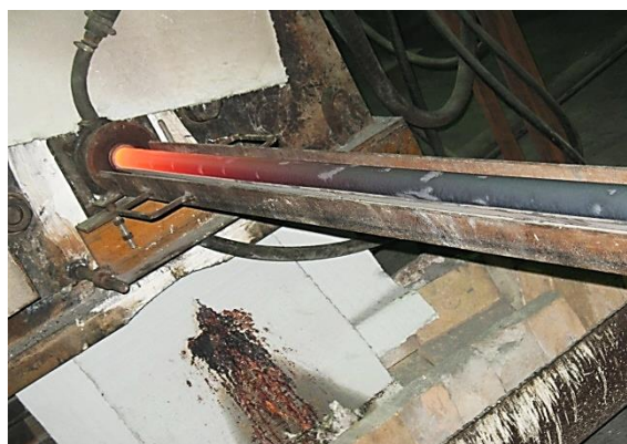
Рисунок 1 – Вытяжка прутка латуни ЛС59 – 1
