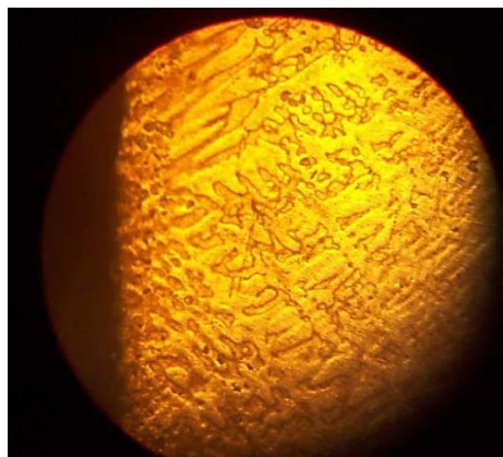
Рисунок 4 – Микроструктура медного литого прутка, x100
