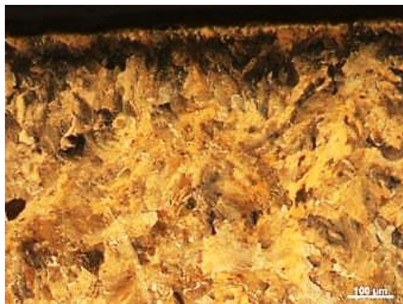
Рисунок 2 – Диффузионный боридный слой на стали У8, толщина слоя около 20 мкм, х 100 (метод контраста – светлое поле); состав: 80 % B_4C + 2 % NaF + 18 % Al_2O_3
