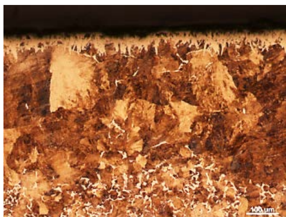
Рисунок 1 – Диффузионный боридный слой на стали 45, толщина слоя около 40 мкм, х 100 (метод контраста – светлое поле); состав: 80 % B_4C + 2 % NaF + 18 % Al_2O_3
