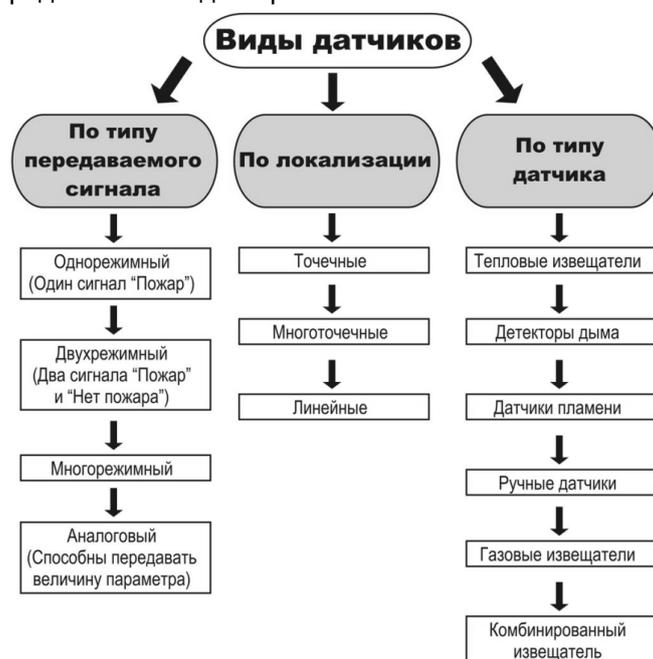
Рисунок 2 – Классификация датчиков пожарной сигнализации
