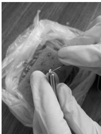
Рисунок 1 – Подключение зерновки пшеницы к плате сбора данных
