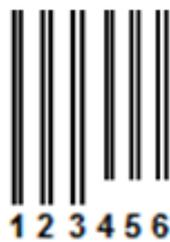
Рисунок 2 – Разработанный тест-объект. Контраст в парных штрихах рассчитывали по известной формуле [7]:
