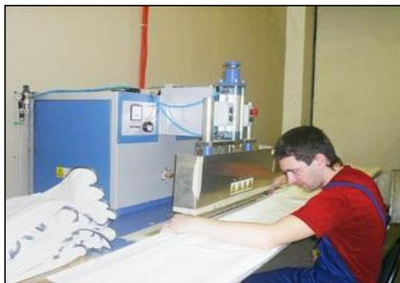
Рисунок 1 – Соединение полотен натяжного потолка с помощью специальной сварки в заводских условиях
