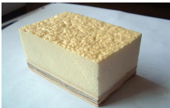
Рисунок 4 – Закрытоячеистый пенополиуретан
