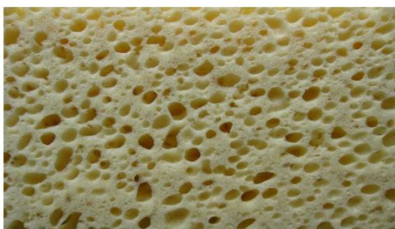
Рисунок 5 – Пенополиуретан с открытоячеистой структурой
