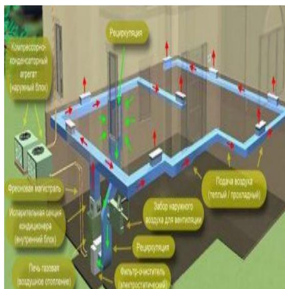
Рисунок 1 – Общая принципиальная схема газозвоздушного отопления
