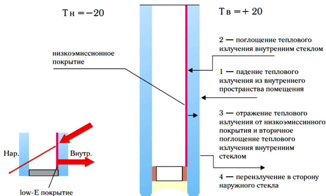
Рисунок 3 – Передача тепла излучением в зимнее время через однокамерный стеклопакет с внутренним низкоэмиссионным стеклом
