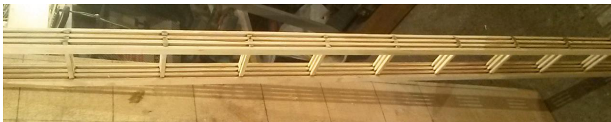
Рисунок 5 – Масштабная модель безраскосной фермы покрытия из досок с клеевыми стыками
