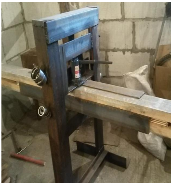
Рисунок 4 – Схема запрессовки клеевых соединений
