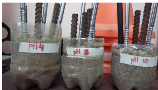
Рисунок 1 – Макеты свай, помещённые в ёмкости с грунтом
