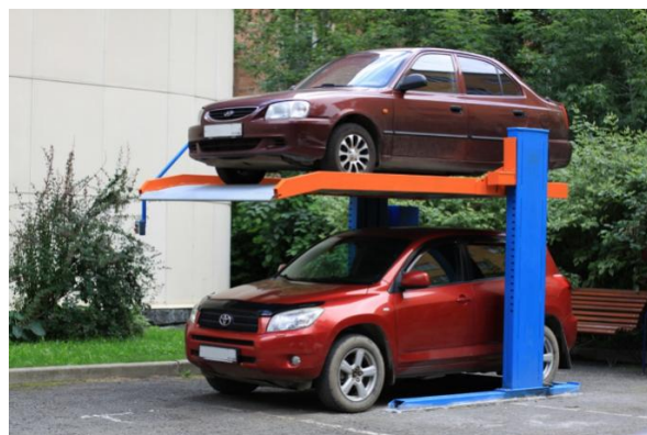
Рисунок 4 – Механизированный комплекс ПАРКИНГ СМА-K2-2-Г
