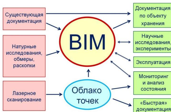
Рисунок 1 – Обобщенная схема использования BIM при работе с архитектурными памятниками
