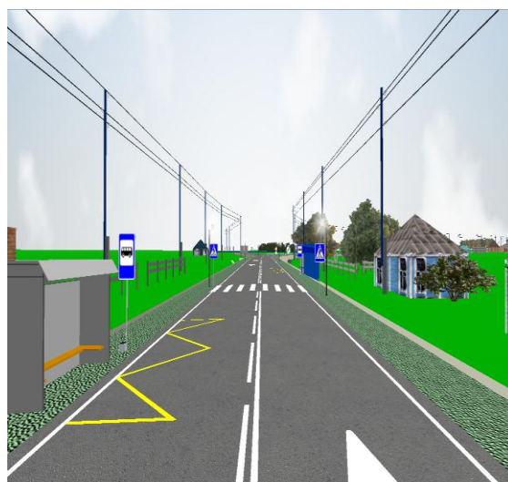
Рисунок 2 – Предлагаемый 3D-вид проектируемого остановочного пункта с размещением ТСОДД
