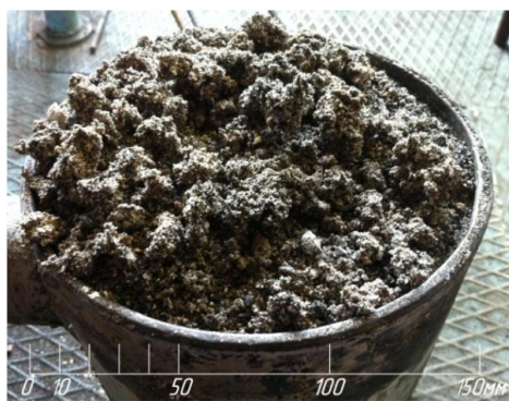
Рисунок 6 – Агломераты слоя, образованные в результате не достаточной подачи воздуха
