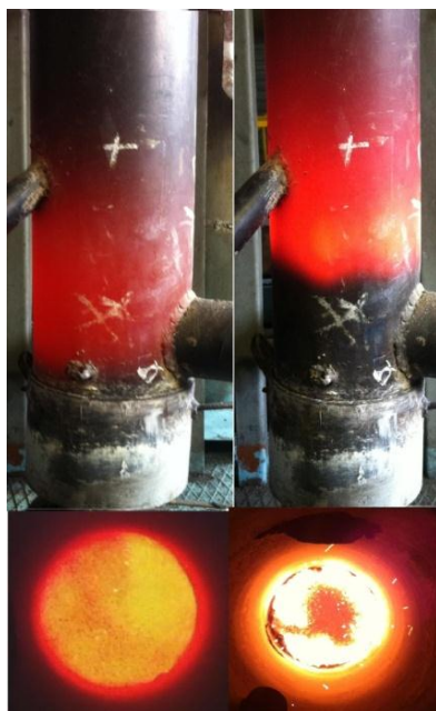
Рисунок 15 – Распространение поля температур на стенках камеры сгорания огневого стенда (слева – слой без содержания крупных частиц в нём, справа зашлакованный слой)
