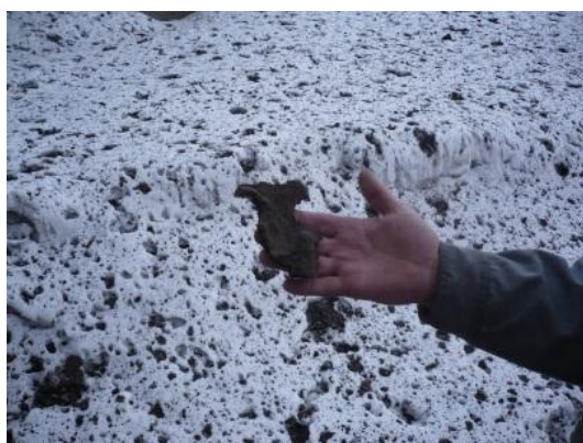
Рисунок 2 – Вынос несгоревшего топлива из дымовой трубы
