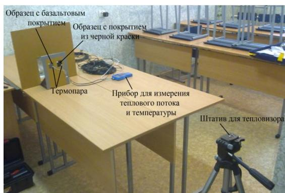
Рисунок 4 – Экспериментальная установка для определения излучательной способности длинноволнового излучения
