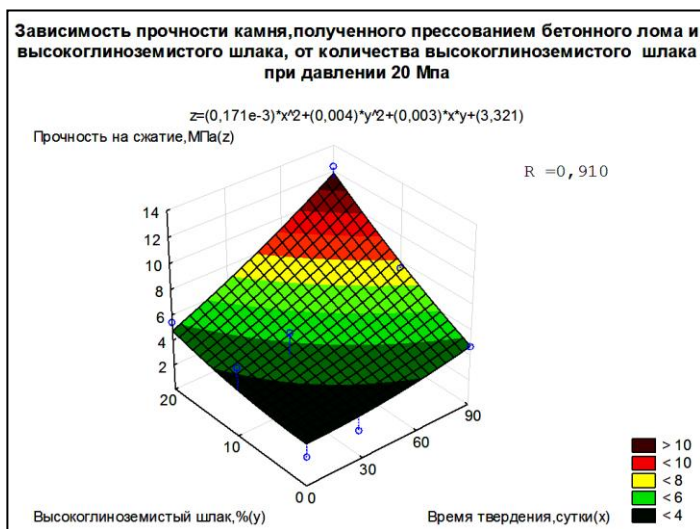
Рисунок 2 – Зависимость прочности образцов из бетонного лома от содержания высокоглиноземистого шлака (ВГШ) и времени твердения при прессовании в 20 МПа
