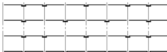
Рисунок 4 – Система с накладками – однопролетные прогоны
