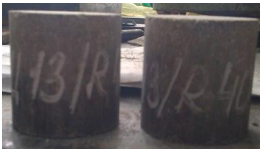
Рисунок 1 – Гиперпрессованные образцы из песка отсева дробления известняка
