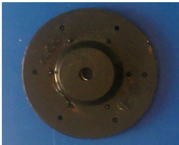
Рисунок 5 – Сварное соединение диска монтажного с заготовкой из полиэтиленового листа толщиной 4,0 мм
