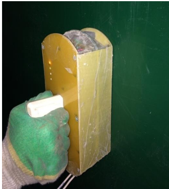
Рисунок 3 - Опытный образец индуктора для сварки листов футеровки с монтажными дисками
