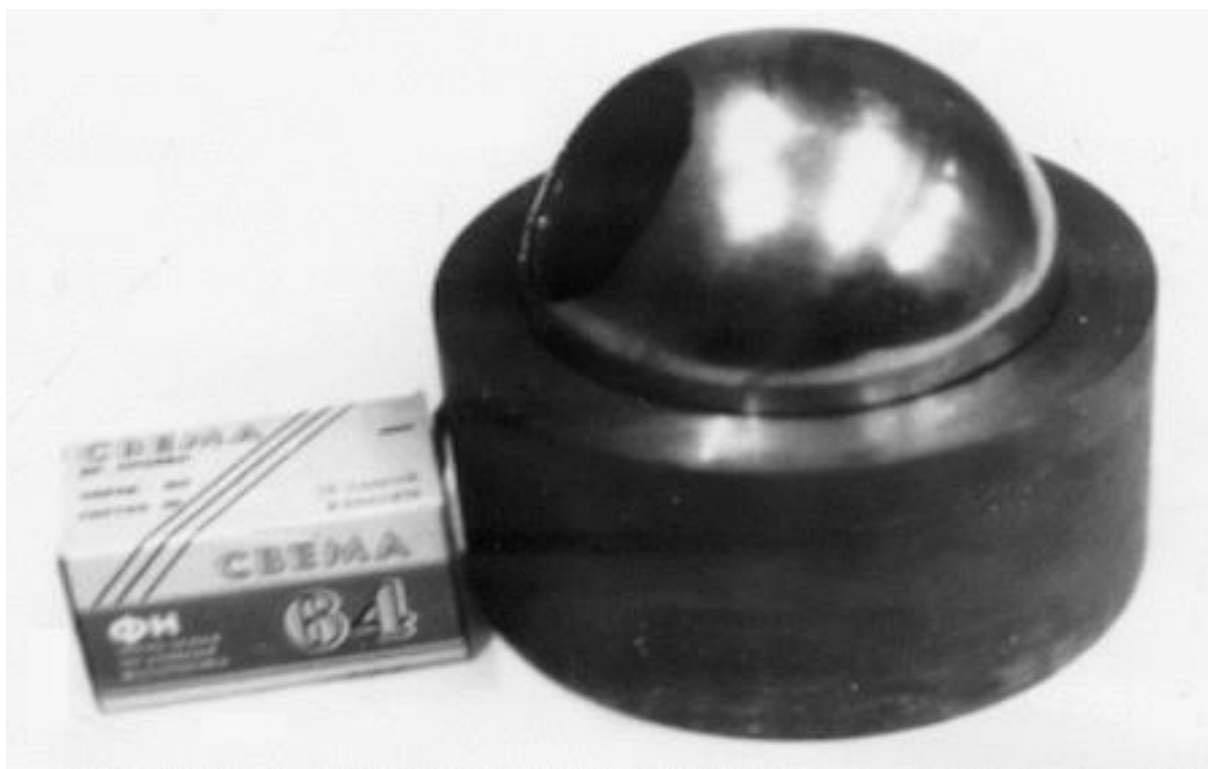
Рисунок 1 - Запорная арматура с уплотнительными поверхностями, упрочненными методом ЭЛН в вакууме
