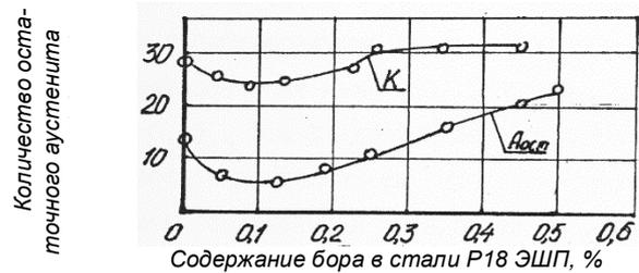
Рисунок 2 – Влияние бора на количество остаточного аустенита в литой стали Р18 ЭШП (закалка с 1280 °С) и карбидов (закалка с 1280 °С + отпуск при 560 °С 3 раза по 1 часу)
