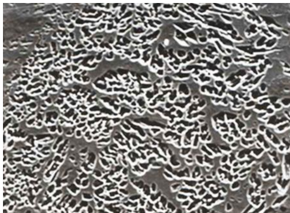
Рисунок 5 – Микроструктура карбидной эвтектики, \times 850
