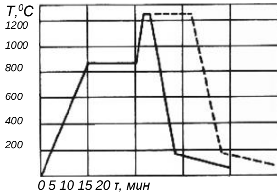
Рисунок 1 – Термический цикл нагрева заготовок в соляных ваннах для получения биметалла: быстрорежущая+ деформированная углеродистая борсодержащая сталь
