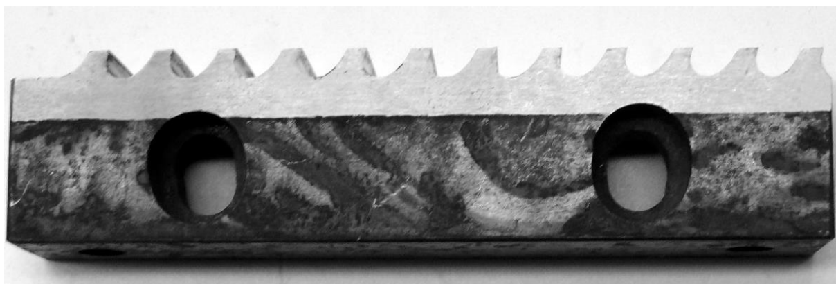
Рисунок 4 – Биметаллическая протяжка, полученная контактно-реактивной пайкой в соляной ванне: верх – быстрорежущая сталь Р6М5К5; низ – деформированная сталь 45 с 0,35 % бора
