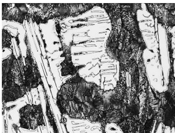
Рисунок 4 – Пластинчатый ледебурит и перлит (экспериментальный образец 4)
