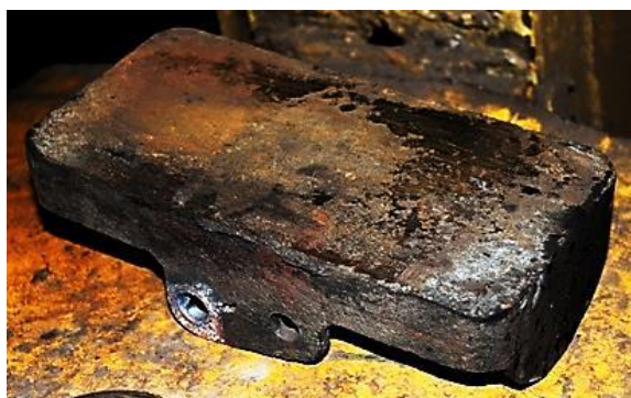
Рисунок 2 – Износ рабочей поверхности колпака скользуна
