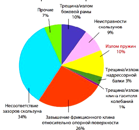
Рисунок 1 – Структура отказов (неисправностей) грузовой тележки вагона
