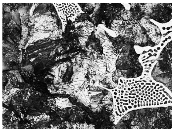
Рисунок 3 – Сотовый ледебурит и перлит (экспериментальный образец 2)
