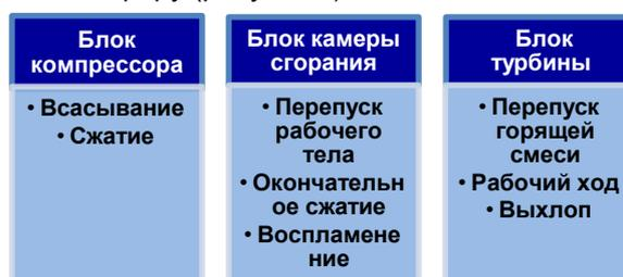
Рисунок 1 – Схема роторного двигателя с перемещением рабочего тела
