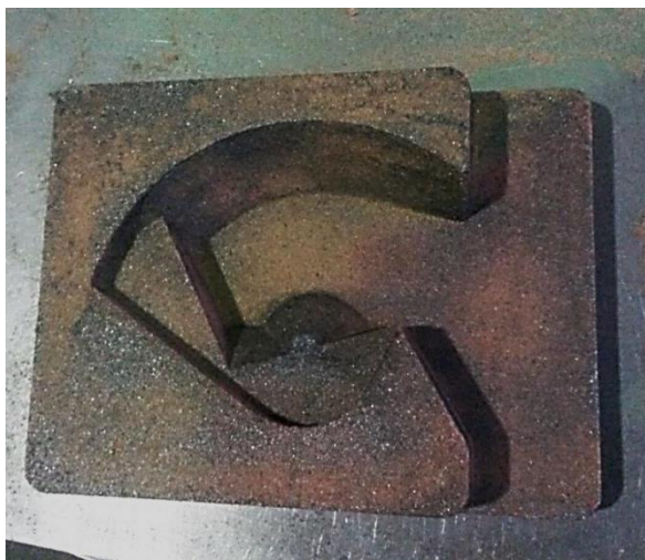
Рисунок 12 – Отливка корпусной детали
