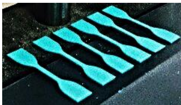
Рисунок 3 – Образцы для испытания на растяжение
