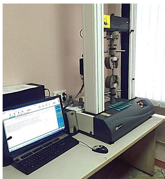
Рисунок 4 – Испытание на растяжение образцов
