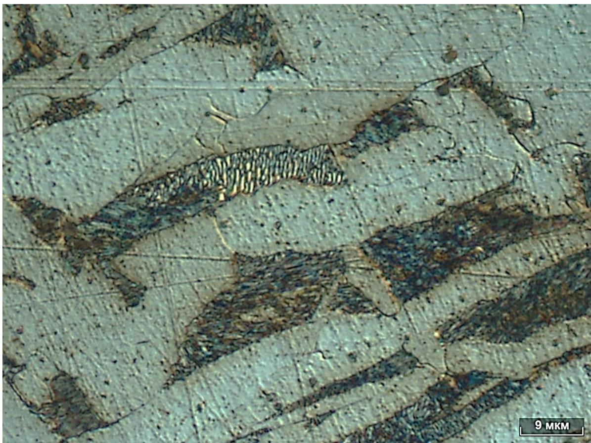
Рисунок 3 – Микроструктура образцов стали Ст3 в исходном состоянии. Травление спиртовым раствором пикриновой кислоты
