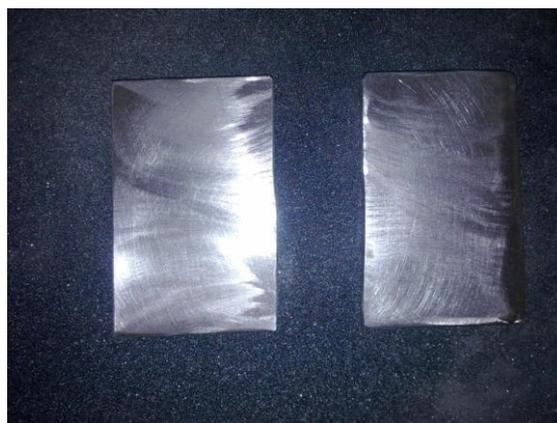
Рисунок 4 – Стальные образцы (60×40×4 мм) стали марки Ст3
