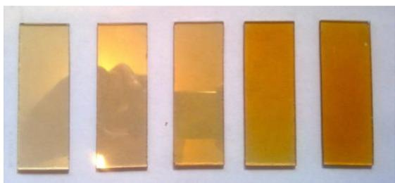
Рисунок 8 – Образцы с разной толщиной базальтового напыления
