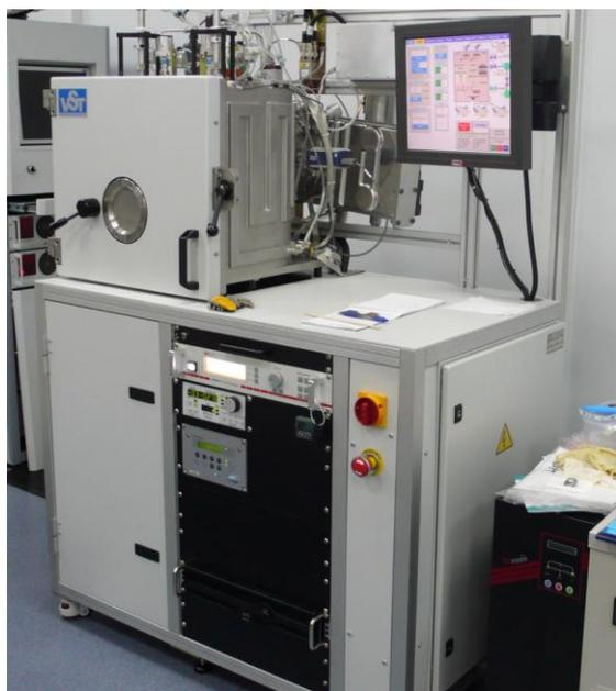
Рисунок 7 – Установка магнетронного напыления
