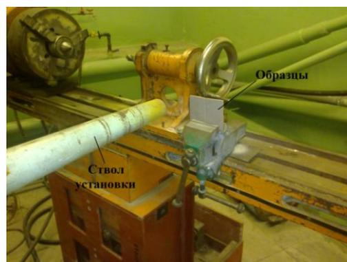
Рисунок 5 – Напыляемые образцы и ствол установки ДГН
