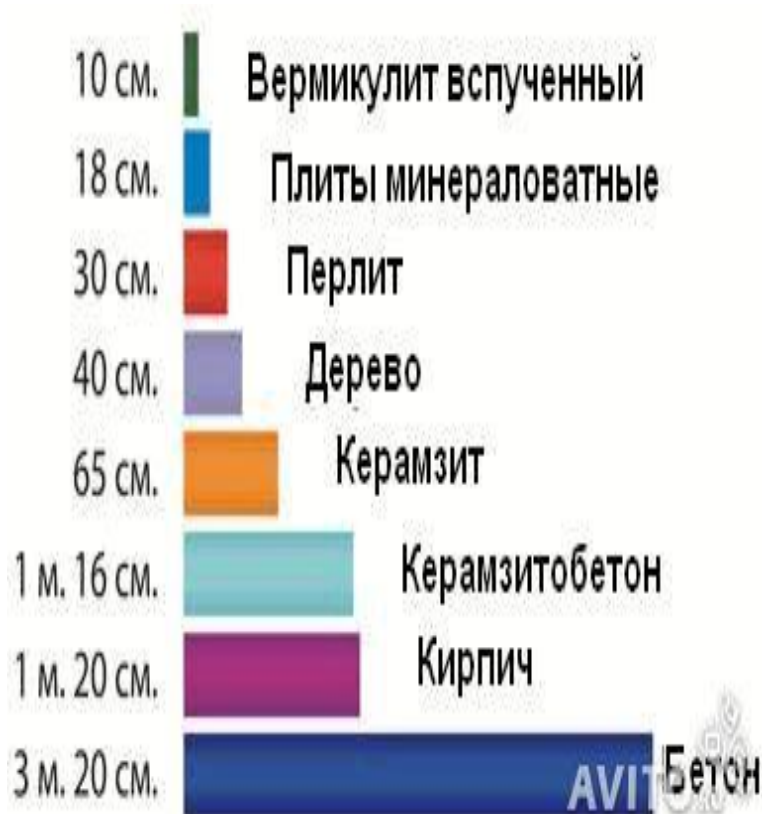
Рисунок 3 – Сравнительная толщина материалов по теплопроводности
