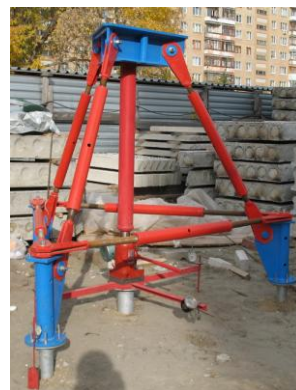
Рисунок 2 – Установка по испытанию винтовых свай «BAU» в натурных (полевых) условиях – УУ-ВСК
